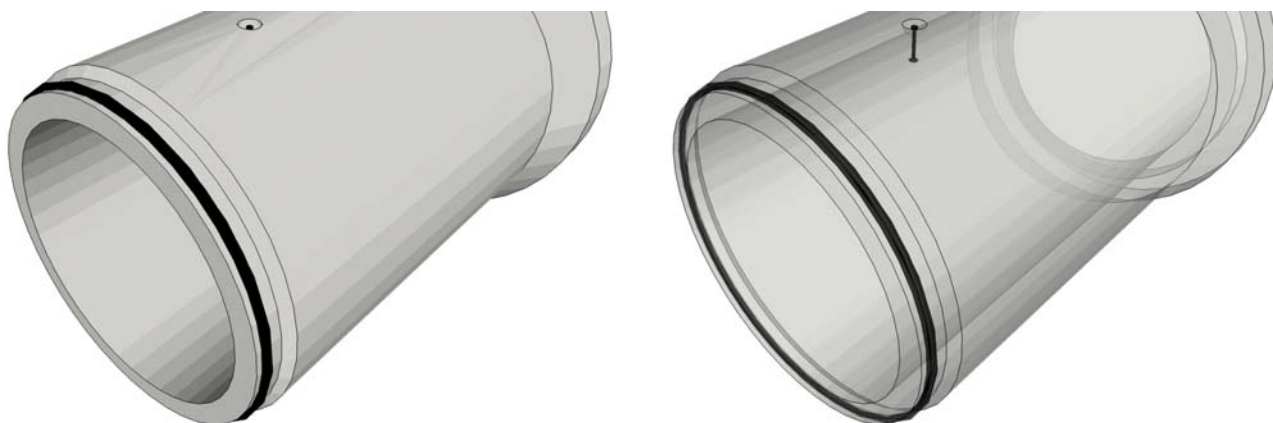
Particolare innesto tubi con guarnizione a rotolamento posizionata su giunto maschio
