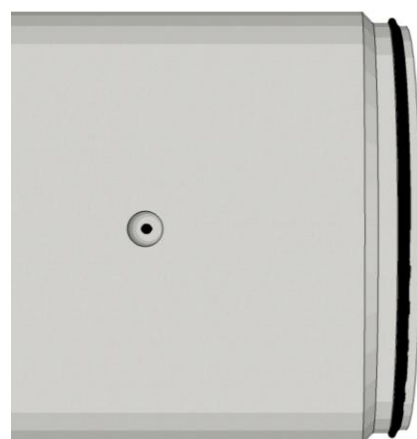
Particolare posizionamento guarnizione a rotolamento su giunto maschio
